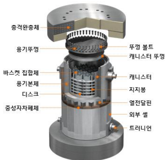
〈사진2〉 사용후핵연료 수송·저장 용기(KORAD-21) 모식도(출처: 한국원자력환경공단 제공)
