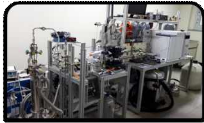
그림 5. 빙하시료 온실가스 분석에 사용된 장비.
